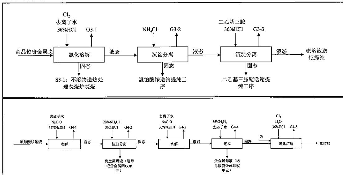
3.3 钯的精炼生产：氯钯酸滤液进入反应釜，在氯酸钠和盐酸的作用下，从 2 价氧化成 4 价，再和氯化铵反应生成氯钯酸铵（红色的盐）沉淀。溶液冷却后过滤，滤液送母液贵金属回收单元，红色的盐转移到下一步溶解工序；氯钯酸铵沉淀中加入去离子水，形成氯化钯。加热至沸腾，促进红色的盐溶解。再加入氨水及氢氧化钠溶液，反应生成二氯四氨钯溶液；二氯四氨钯中加入盐酸生成二氯二氨钯沉淀，过滤后二氯二氨钯沉淀进入下一工序，母液送母液贵金属回收单元；在二氯二氨钯中加入氨水，转化成二氯四氨钯溶液，溶液进入下一步工序；二氯四氨钯溶液中加入盐酸生成二氯二氨钯沉淀，过滤后二氯二氨钯沉淀进入下一工序，母液送母液贵金属回收单元；二氯二氨钯中加入氨水，转化成二氯四氨钯溶液，加入水合肼溶液将二氯四氨钯还原成金属钯，滤液送母液贵金属回收单元。
